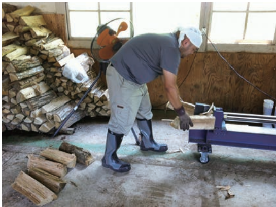
薪割り作業の様子。45cm幅に切られたナラ材を、薪機械でさらに割っていきます。
