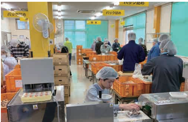
パックセンターの中では、椎茸の選別やパック詰め、ラップ掛け、シール貼りといった作業が一連の流れの中でスムーズに行われています
