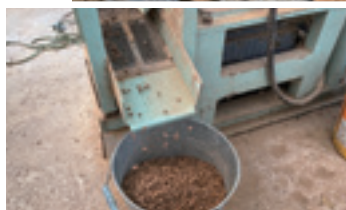
粉碎機でパウダー状にした物(写真上)を機械で圧縮し、 ペレットを製造します。(写真下)。
